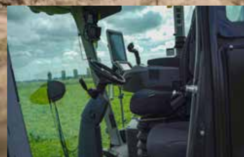
Cabine Claas. silencieuse, suspendue, cruise control, siège Grammer et siège passager
