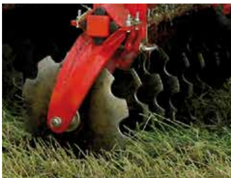
Aggressive Scheibenform und -stellung garantieren sehr guten Einzug und beste Einmischung
